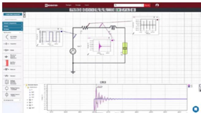
Ce dernier est un environnement complet de conception, modélisation, simulation et analyse de circuits et de systèmes électroniques et mécatroniques utilisé par les 1,3 million de membres de la communauté d'ingénierie DesignSpark.
